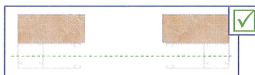
Si les murs ne sont pas plans, inclure une cale permettant aux coulisses d'être fixées parallèlement. (Figure ci-dessous).
